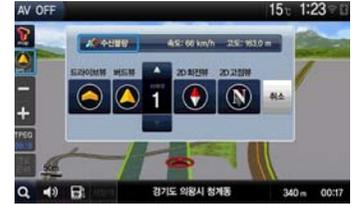
② 현재 GPS 상태, 차량의 속도 및 고도를 확인할 수 있으며 GPS 수신 상태가 양호함을 나타냅니다.
